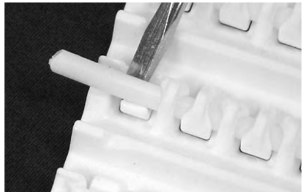
Figura 176: Levante a vareta sobre a peça de retenção
