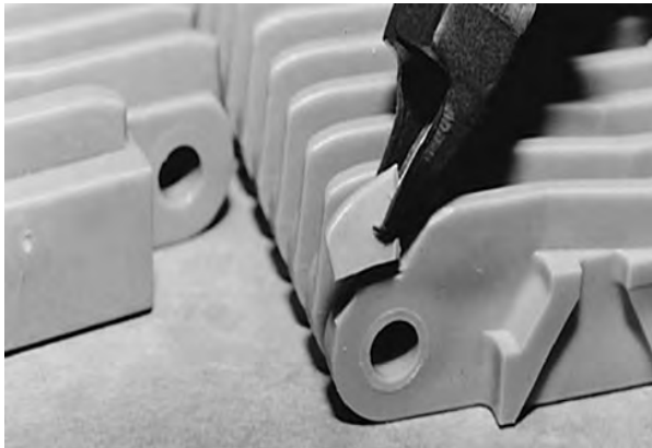
Figura 47: Corte a viga externa
