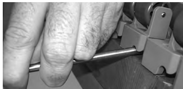
Figura 193: Insira o pino de aço na articulação
