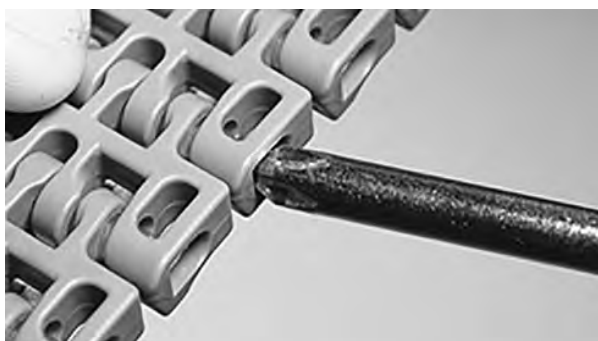
Figura 145: Empurre a vareta, passando pela peça de retenção
