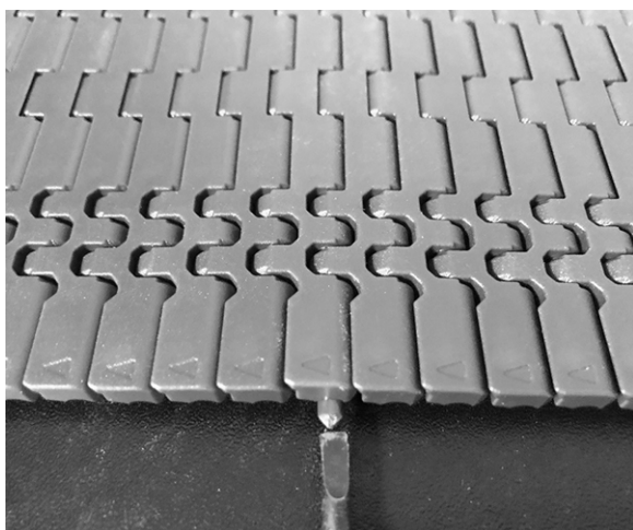
Figura 59: Empurre a vareta, passando pela peça de retenção
