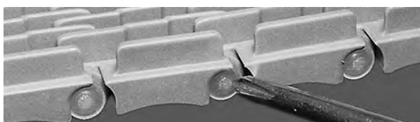
Figura 23: Confirme que a cabeça da haste esteja além do travamento por pressão
