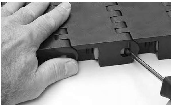
Figura 257: Abra o Slidelox
