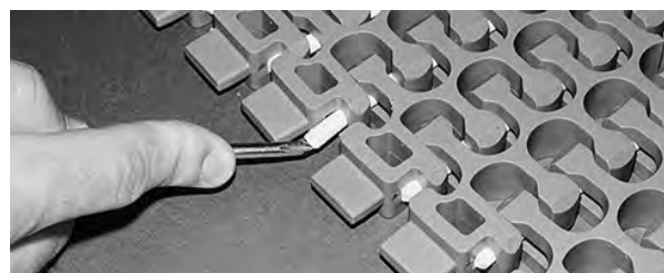
Figura 271: Confirme que a vareta passe pela peça de retenção
