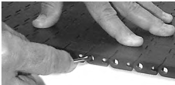
Figura 163: Abra o Slidelox
