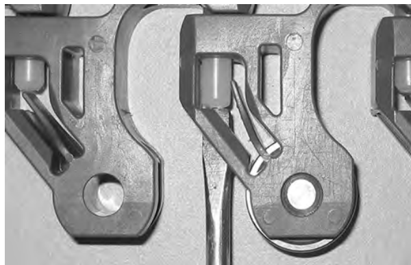
Figura 278: Empurre a vareta, passando pela peça de retenção
