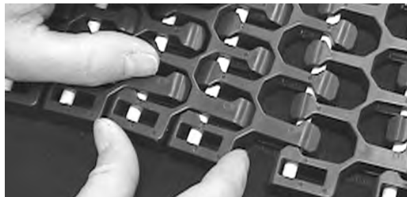
Figura 308: Confirme que a vareta esteja totalmente inserida
