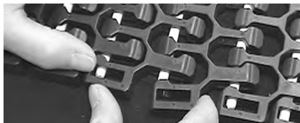
Figura 307: Empurre a vareta para além da borda da esteira e encaixe a borda lisa sobre a vareta
