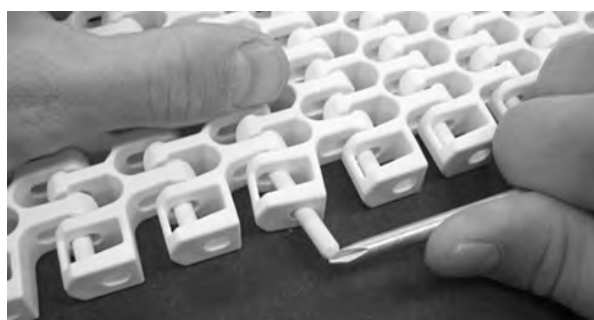
Figura 288: Empurre a vareta, passando pela peça de retenção
