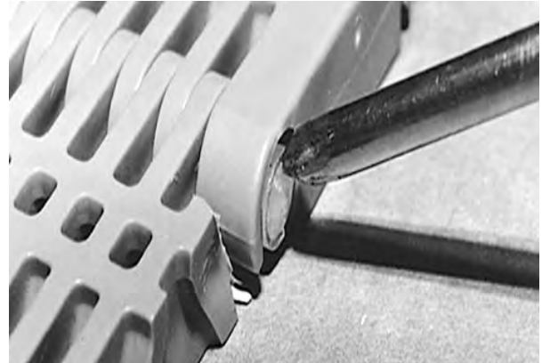
Figura 48: Empurre a vareta, passando pela peça de retenção
