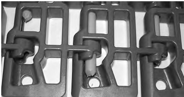
Figura 124: Confirme que a vareta esteja totalmente inserida
