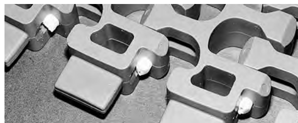
Figura 272: Confirme que a vareta esteja totalmente inserida
