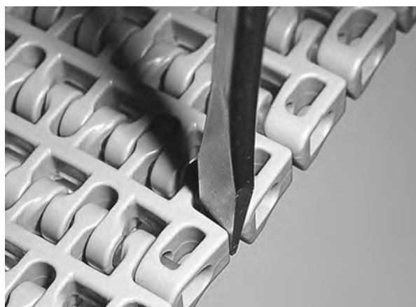
Figura 138: Empurre a vareta, passando pela peça de retenção
