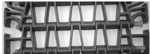
Figura 255: Confirme que a vareta passe pela peça de retenção
