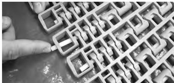
Figura 338: Empurre a vareta, passando pela peça de retenção
