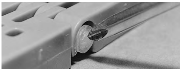
Figura 38: Confirme que a cabeça da haste esteja além do travamento por pressão
