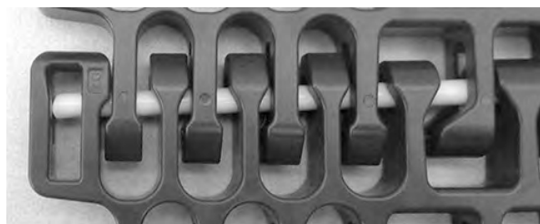
Figura 315: Confirme que a vareta passe pela peça de retenção
