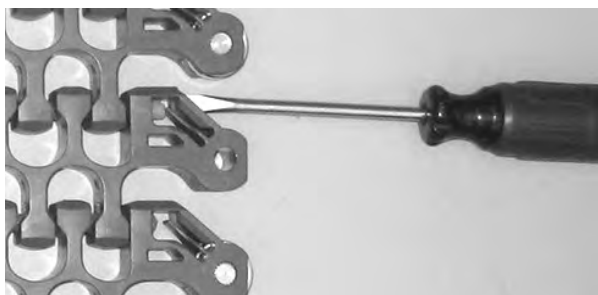
Figura 298: Abra a peça de retenção
