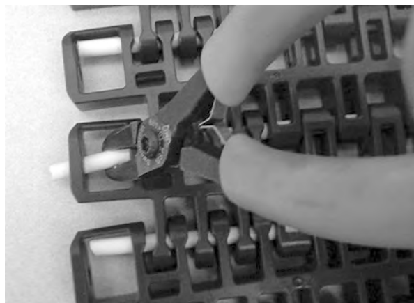
Figura 357: Empurre a vareta, passando pela peça de retenção
