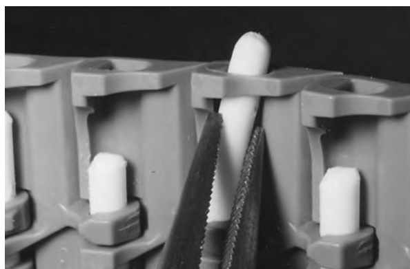
Figura 148: Empurre a vareta, passando pela peça de retenção
