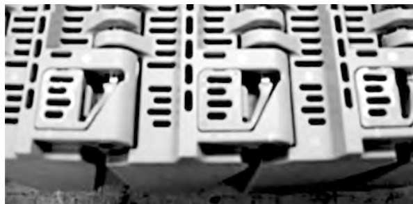
Figura 105: Confirme que o recurso de retenção esteja fechado
