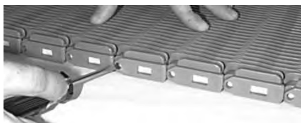
Figura 43: Abra o Slidelox
