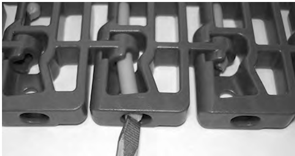
Figura 123: Empurre a vareta, passando pela peça de retenção
