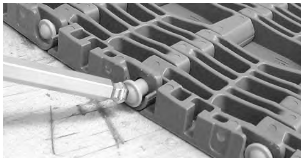
Figura 267: Empurre a mini-vareta através da peça de retenção
