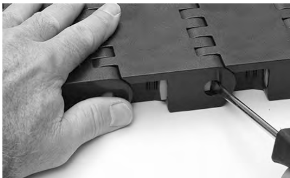
Figura 260: Abra o Slidelox
