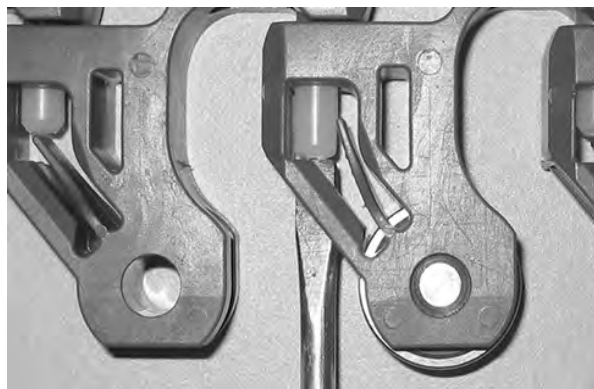
Figura 300: Empurre a vareta, passando pela peça de retenção
