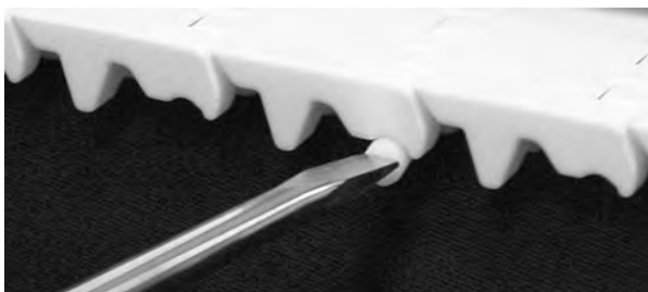
Figura 174: Empurre a vareta, passando pela peça de retenção
