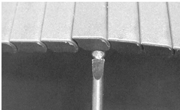
Figura 54: Empurre a vareta, passando pela peça de retenção
