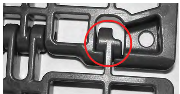
Figura 121: Elo posicionado corretamente
