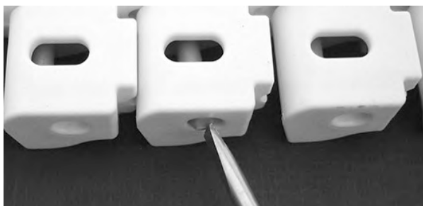
Figura 283: Empurre a vareta, passando pela peça de retenção
