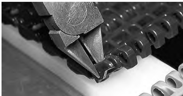
Figura 140: Corte metade da borda
