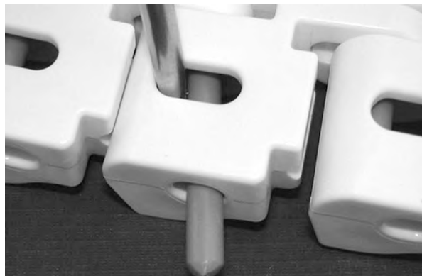
Figura 285: Empurre a vareta através da peça de retenção
