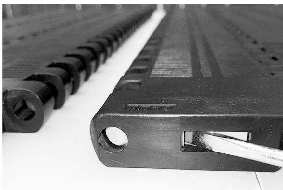
Figura 209: Use uma chave de fenda para fechar o Slidelox
