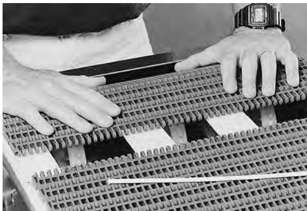
Figura 13: Pressione as extremidades da esteira
