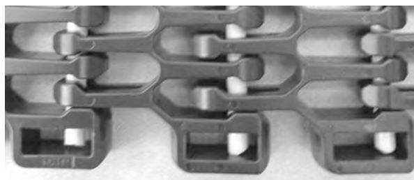
Figura 326: Confirme que a vareta esteja totalmente inserida
