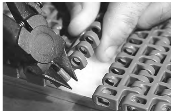
Figura 152: Corte a borda da esteira
